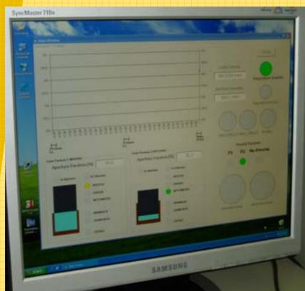
**Ogni singola variabile del processo ( livello vasca di carico, posizione paratoie, azionamenti sulle stesse ) è visualizzata su un monitor e memorizzata in un file di testo. Viene anche redatto un archivio storico delle anomalie dell'impianto.**
